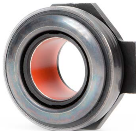
Foto 3: Łożyska oporowe z tuleją pokrytą PTFE nie mogą być smarowane
