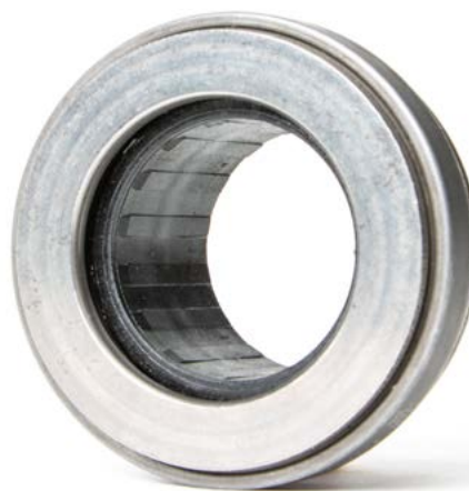
Foto 2: Łożyska oporowe z plastikową tuleją nie mogą być smarowane
