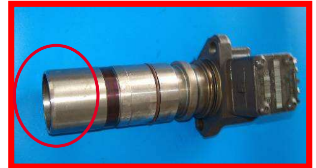
Podzespół niekompletny (brak popychacza)
